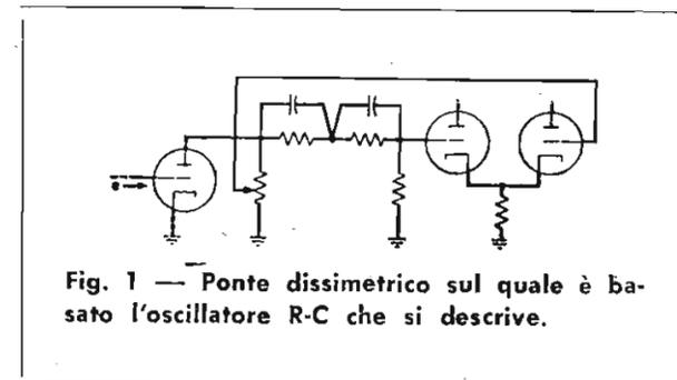
vole mediante un potenziometro resistivo disposto in derivazione alla tensione anodica e ciò allo scopo di permettere l'impiego di resistenze di elevato valore nel circuito catodico, a beneficio della stabilità di frequenza.
