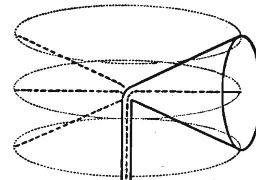
Fig. 2 — Facendo compiere al sistema radiante di fig. 1b una rotazione di 360° si ottiene il sistema radiante di fig. 3, che costituisce l'antenna Discone.
