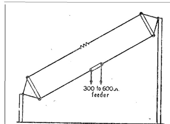
Fig. 1 — Antenna TFD, « *terminated folded dipole* », che è illustrata in quest'articolo dal suo ideatore. Quest'antenna accoppia le dimensioni ridotte con la possibilità d'impiego su una vasta banda di frequenze.
