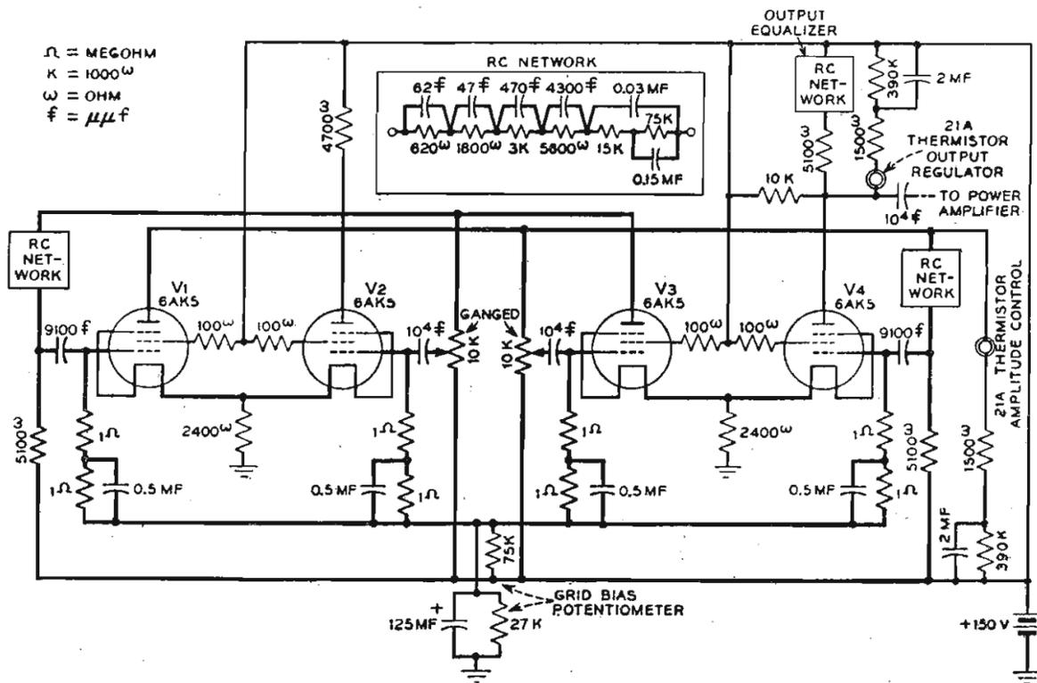
Fig. 2 — Circuito elettrico dell'oscillatore R-C ad ampia banda descritto. L'oscillatore copre in un'unica gamma un campo di frequenza che si estende da 20 Hz a 3 MHz.
