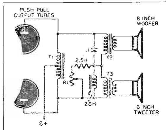
T1 è il normale trasformatore d'uscita del ricevitore o amplificatore; il suo secondario non viene usato. T2 e T3 sono dei piccoli trasformatori d'uscita e l'impedenza primaria di ciascuno di essi è eguale al valore dell'impedenza (fra le placche) consigliato per le valvole usate. R1 serve quale controllo di tono e taglia le frequenze più elevate del canale dei bassi. L'Autore impiega un potenziometro da 0,5 M-ohm, ma probabilmente valori inferiori danno migliori risultati.
