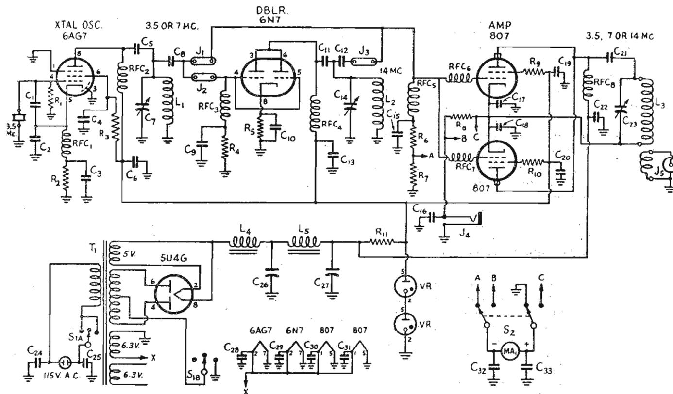
Fig. 1 — Circuito elettrico del trasmettitore da 75 watt per grafica per le bande dei 80, 40 e 20 metri. Il trasmettitore è completo, in quanto comprende anche l'alimentatore, e per il passaggio di banda l'unica induttanza da intercambiare è quella dello stadio finale.
