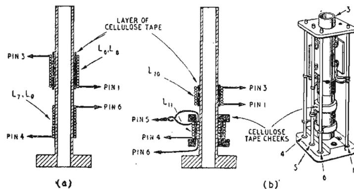
Fig. 2 — Dettagli costruttivi relativi alle induttanze ed ai trasformatori di MF. Tutti i dati sono elencati nella tabella.
