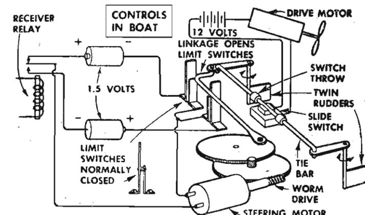
Fig. 4 — Dispositivo di controllo montato sull'imbarcazione e collegato al relé del ricevitore. Oltre al motore di avanzamento è previsto un eguale motore ausiliario che provvede a far ruotare la barra del timone. Un dispositivo di sicurezza evita che l'imbarcazione possa sfuggire al controllo.
