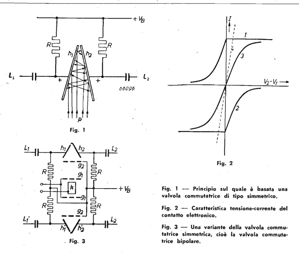
Fig. 1 — Principio sul quale è basata una valvola commutatrice di tipo simmetrico.
